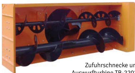
Zufuhrschnecke und Auswurf turbine TB-2202-2602
